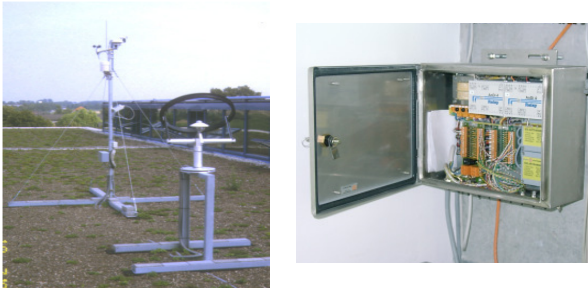
Abb. 44: Links: Wetterstation an zwei Geräteträgern auf dem Dach der Produktion mit Sensoren zur Messung der lokalen meteorologischen Daten. Rechts im Hintergrund ist die Atriumverglasung sichtbar. Rechts: Schaltkasten der Wetterstation im Gebäude mit Verstärkern und Analog/Digital Umsetzter mit M-Bus Ausgang.
