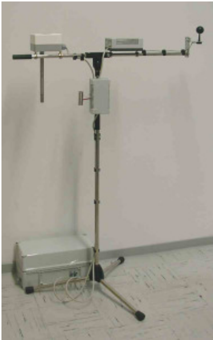
Abb. 52: Intensivmessung in einem Büro im EG. An dem Stativ sind ein Sensor für die relative Luftfeuchte, ein Lufttemperatur- und ein Strahlungstemperatursensor („Globekugel“) montiert (im Bild von links nach rechts am Stativ sichtbar).
