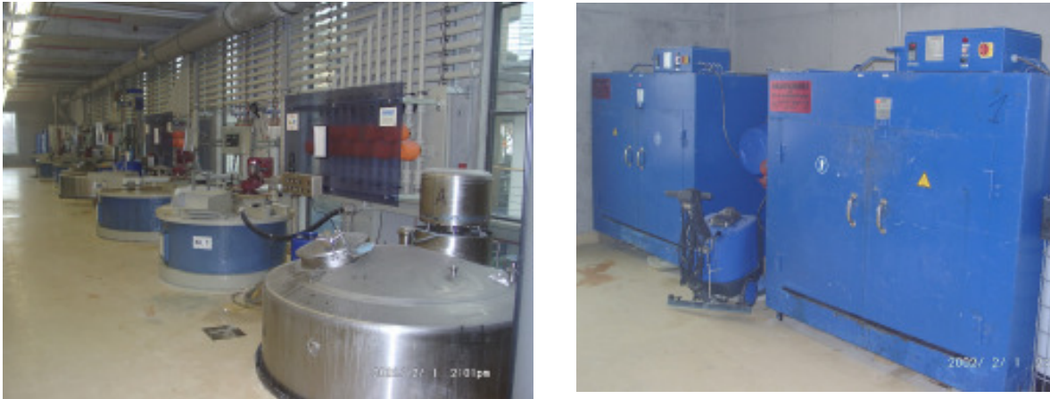
Abb. 5: Links : Blick in die Produktion im 1. OG mit den Rührbehältern. Diese reichen bis in das drunter liegende Geschoss. Rechts : Elektrische Wärmeschränke im Bereich der Produktion im 1. OG.
