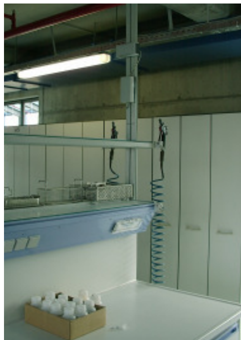
Abb. 51: Auswahl einiger Lufttemperaturmessungen im Gebäude. Oben zwei Messstellen im Atrium (Ausgang Nord EG unter dem Feuermelder und über der Abluftansaugöffnung im 2. OG) und unten links eine Messstelle an einer Büro-Innenwand sowie unten rechts die Messstelle am Pfosten eines Labortisches im 2. OG.
