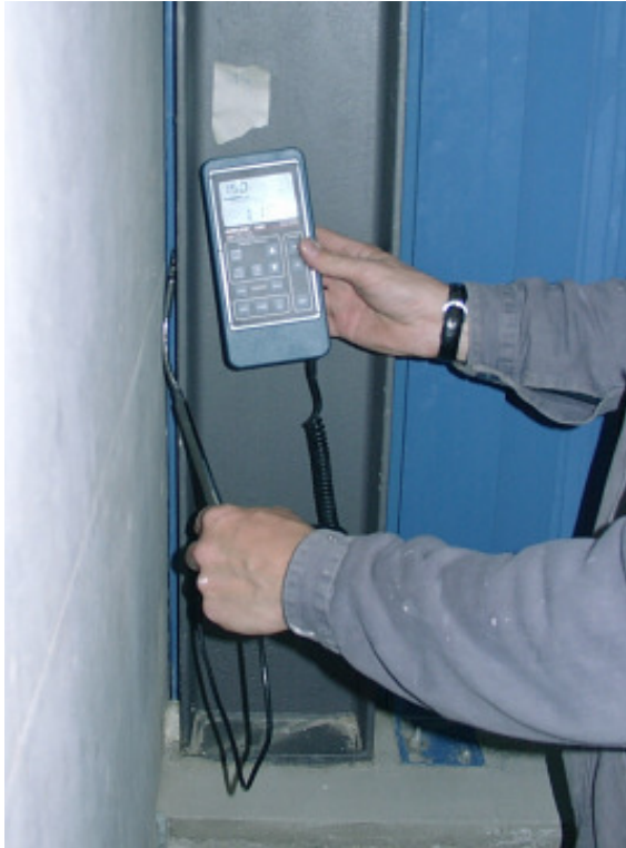
Abb. 25: Die Verbindung der Atrium-Nordfassade (Pfosten-Riegel-Konstruktion) an die westliche (linkes Bild) und die östliche (rechtes Bild) Betonwand ist auf der gesamten Höhe nicht ausreichend luftdicht.
