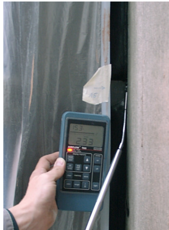
Abb. 25: Die Verbindung der Atrium-Nordfassade (Pfosten-Riegel-Konstruktion) an die westliche (linkes Bild) und die östliche (rechtes Bild) Betonwand ist auf der gesamten Höhe nicht ausreichend luftdicht.
